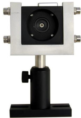
Abbildung 7: Die Photodiode in ihrer Haltevorrichtung. In der Mitte ist die 0,5 mm große aktive Fläche zu sehen, auf die der Interferenzstreifen fokussiert wird. ©Fraunhofer EMI.
